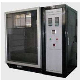
该仪器按照 GB/T12704-2009《织物透湿量测定方法 透湿杯法/方法 A 吸湿法》设计制造，适用于测定各类织物（包括透湿型涂层织物）以及絮棉、太空棉等用于服装非织造物的透湿（汽）性。采用透湿杯吸湿法测定水蒸气透过织物的能力。透湿性可反映服装排汗、汽的性能，是鉴定服装的舒适性、卫生性的重要指标之一
