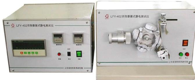
本机按照 ZBW04009-89《织物摩擦起电电压测定方法》设计制造，在试验室条件下，用于评定以摩擦形式带电后的织物或纱线及其它材料的静电特性。
