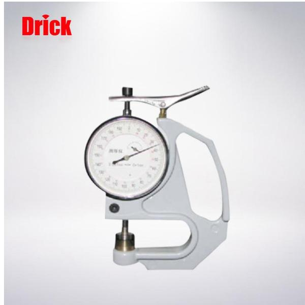
DRK203B 本测厚仪是用机械测量法测定塑料薄膜和薄片厚度的仪器，但不是适用于压花的薄膜和薄片。
