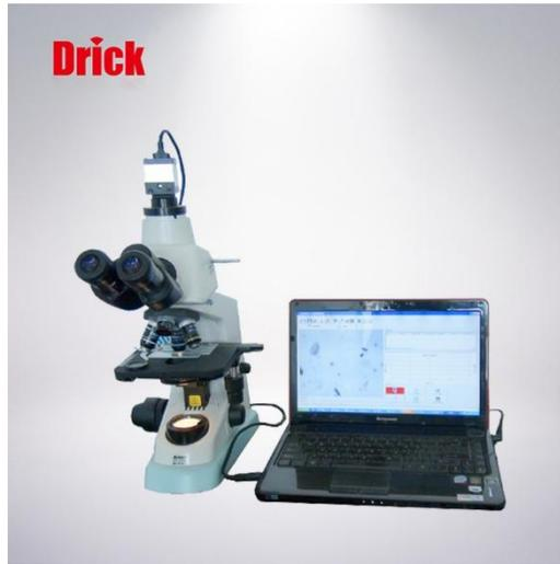
DRK3600 炭黑分散度检测仪，用于检测聚烯烃管材、管件及混配料中颜色和炭黑的分散度；通过对炭黑粒团的尺度、形态、以及散布情况的测量，可以建立起这些参数与力学性能、抗静电性能、吸湿性能等宏观性能指标的内在联系，这将对塑料材料的品质保障、生产工艺、新品研发产生积极影响，同时推进企业和行业技术水平地快速提升。本仪器符合国际标准 GB/T 18251-2019，关键部件采用了进口的 NIKON 双目显微镜，高分辨率、高清晰度的 CCD 相机，配合强大的软件功能支持，能够快捷准确地测得粒子或粒团的尺寸及其分散度，全部过程实现自动化，用户只需要实现加样，软件自动实现颗粒图片的采集，自动保存，自动计算各种参数。
