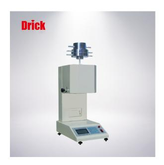
XRL-401B 熔体流动速率测定仪是用于测定热塑性塑料熔体质量流动速率 (MFR; 单位: g/10min) 的仪器。该仪器执行 JB/T5456 标准要求,适用 GB/T3682、ISO1133 等标准,广泛用于塑料熔融指数值的测定。
