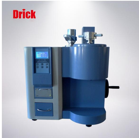
XRL-400D 熔体流动速率仪是用来表征热塑性高聚物在粘流状态时流动性能的仪器，用来测定热塑性树脂的熔体质量流动速率（MFR）和熔体体积流动速率（MVR），熔体流动速率仪既适用于熔融温度较高的聚碳酸酯、尼龙、氟塑料、聚芳砜等工程塑料，也适用于聚乙烯、聚苯乙烯、聚丙烯、ABS 树脂、聚甲醛树脂等熔融温度较低的塑料测试，广泛地应用于塑料原料、塑料生产、塑料制品、石油化工等行业和相关的大专院校、科研单位、商检部门。
