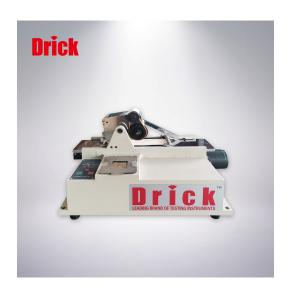
DRK150型油墨吸收性测定仪是依据 GB12911—1991《纸和纸板油墨吸收性的测定法》设计、制造的。该仪器是测定纸或纸板在规定时间及面积上吸收标准油墨性能的仪器。
