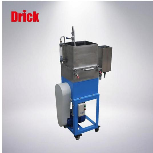
DRK115-A 标准筛浆机，是按照 TAPPI 275 标准制造生产的实验室专用纸浆筛浆机（Somerville 型设备），在实验室中筛浆机通过筛板的上下振动，把纸浆中大的胶粘物、塑料、泥沙、铁屑等杂质分离出来进行检查和量化，并能从筛板下方得到符合规范的良浆。
