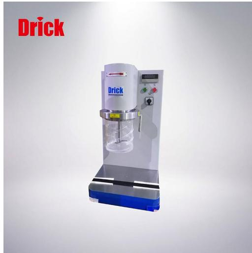
DRK28L-2 标准疏解机(又名立式标准纤维疏解器、标准纤维解离器、标准纤维搅拌器), 是通过使纸浆的纤维原料在水中高速旋转, 将束纤维离解为单纤维的标准离解机。用于手工抄纸的调制, 滤水度的测定以及筛选的试料准备工作。
