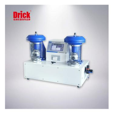
DRK109ST 气动双头耐破度仪是国际通用型缪纶 (Mullen) 式仪器是纸和纸板强度性能检测的基本仪器,本仪器操作简单、性能可靠、技术先进,是科研单位、造纸厂家、包装行业、质检部门不可缺少的理想设备。用于测定各种单层纸张及不高于 2000kpa 的薄纸板也可用于丝绸棉布等非纸制品的检测。
