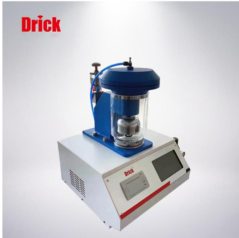
DRK109 纸板耐破度仪是国际通用型缪伦（Mullen）式仪器是纸和纸板强度性能检测的基本仪器。用于测定各种纸板及单层和多层瓦楞纸板，也可用于丝绸、棉布等非纸质材料的耐破强度的测试。
