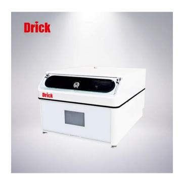
DRK311W 水蒸气透过率测试系统,专业、高效、智能的 WVTR 高端测试系统,适用于塑料薄膜、复合膜等膜、医疗、建筑领域等多种材料的水蒸气透过率的测定。通过对水蒸气透过率的测定,达到控制与调节包装材料等产品的技术指标。采用透湿杯称重法测试原理,在一定的温度下,使试样的两侧形成特定的湿度差,水蒸气透过透湿杯中的试样进入干燥的一侧,通过测定透湿杯重量随时间的变化量,求出试样的水蒸气透过率等参数。
