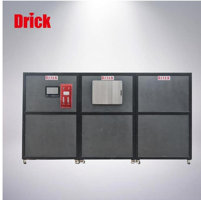
阻塞试验原理：过滤器及面罩阻塞测试仪是用于测试在一定的粉尘环境下，通过吸气的方式气流通过过滤器，达到一定的呼吸阻力的时候，过滤器上所收集到的粉尘数量，测试样品的呼吸阻力和过滤器穿透力（渗透）。
