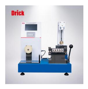
DRK182 纸板层间结合强度测试仪主要用于纸板之纸层剥离强度即纸张表面纤维间结合强度,试验纸板试片,受一定之角度及重量冲击之后所吸收之能量,并显示纸板层间剥离之强度。仪器各项性能参数和技术指标符合美国 Scott 提出的 UM403 层间结合强度的测定方法等标准规定,主要适用于各类纸张表面层间结合强度的测定。是纸管生产企业、质量检测机构等部门的理想检测设备。
